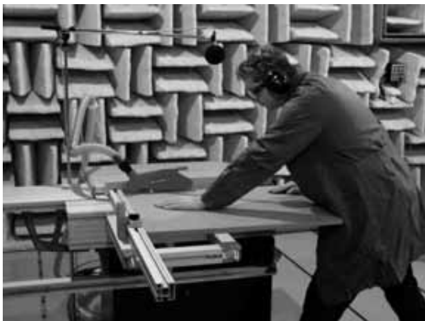
Bild 1: Geräuschmessung beim Sägen im Semi-Schallschluckraum
