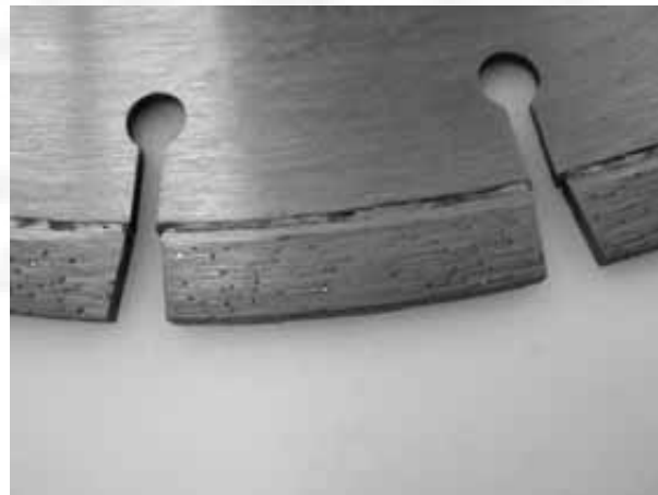
Bild 6: Diamanttrennscheibe mit hohem Leerlauf-Geräuschpegel
